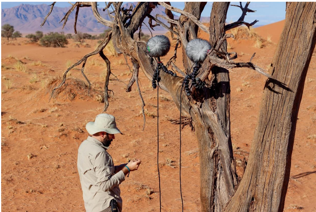
El equipo de grabación favorito de George emplea cuatro MKH 8020 colocados alrededor de un árbol: una grabación relacionada con la cabeza
